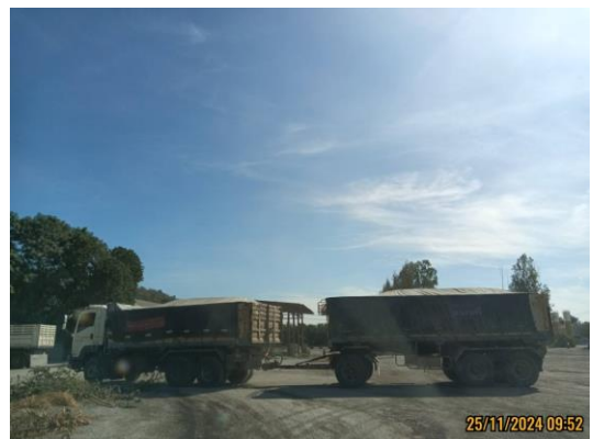
รูปที่ 3-25 ปิดคลุมท้ายรถบรรทุกในการขนส่งแร่
