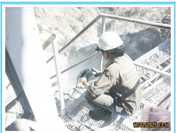
รูปที่ 4.3-16 แสดงการตรวจวัดค่าความทึบของฝุ่นละออง (Opacity) บนเครื่องย่อยที่ 2 (Secondary Crusher) วันที่ 22 พฤศจิกายน 2567
