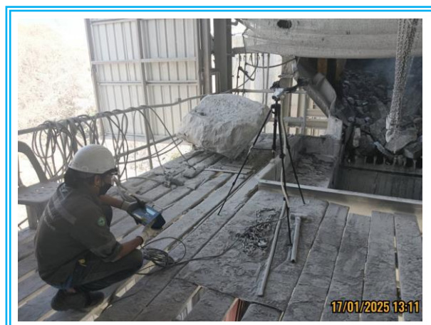
รูปที่ 4.3-15 แสดงการตรวจวัดค่าความทึบของฝุ่นละออง (Opacity) ใต้ปากโม (Primary Crusher) วันที่ 22 พฤศจิกายน 2567
